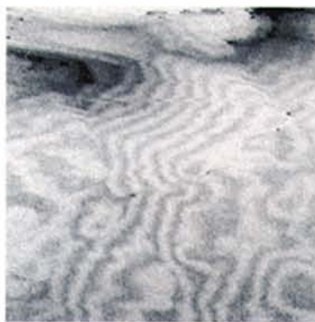
Figura 10. Imagen de 25 \mu\text{m} \times 25 \mu\text{m} de una muestra de Pr 0.67 Sr 0.33 MnO 3 con estructura de perovskita.
