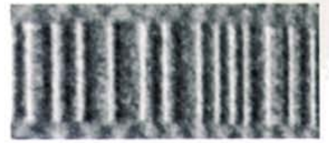
Figura 3.d. Imagen de MFM de un soporte flexible de almacenamiento de datos (ZIP). El tamaño es de 25 \mu\text{m} \times 11 \mu\text{m} . Las bandas claras y oscuras corresponden a las paredes que separan los dominios magnéticos.
