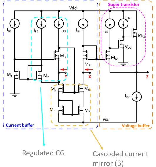
$$r_{X} = \frac{\left(ro_{7} + ro_{6} + gm_{6}ro_{6}ro_{7}\right)\left(ro_{IB4} + \frac{1}{gm_{8}}\right)}{\left(ro_{7} + ro_{6} + gm_{6}ro_{6}ro_{7} + ro_{IB4} + \frac{1}{gm_{8}}\right)}$$
